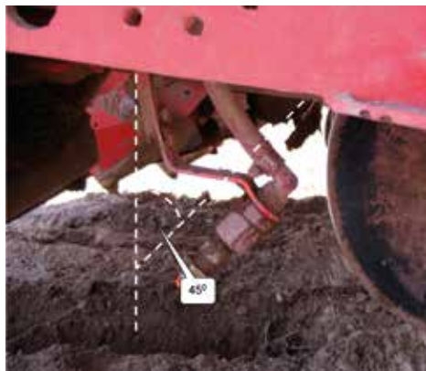
Правильна установка розпилювача — 45–55 градусів від вертикалі
